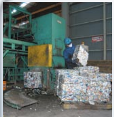
④磁石によってアルミ缶とスチール缶を分ける缶選別機で分別。その後別々にプレスされる。プレスされたアルミ缶の1つの固まりは約400kg。これがアルミを再生する工場へ運ばれる
