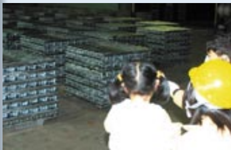
④決まった型に入れてアルミ地金を作る。乾燥させたら、いろいろなアルミ製品を作る工場へ運ばれる
