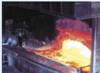
③使われる製品ごとの規格に合わせて、アルミにシリコンなどの材料を混ぜる
