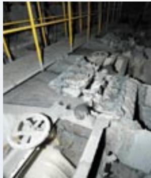
⑤液の中に空気を吹き込んで泡立て、インクとパルプに分離させる
