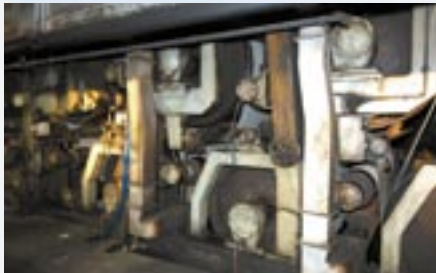
⑥回転するワイヤーの上にパルプを吹き付けて、シートを作る。その後乾かし、ローラーでプレスして表面を平らにする
